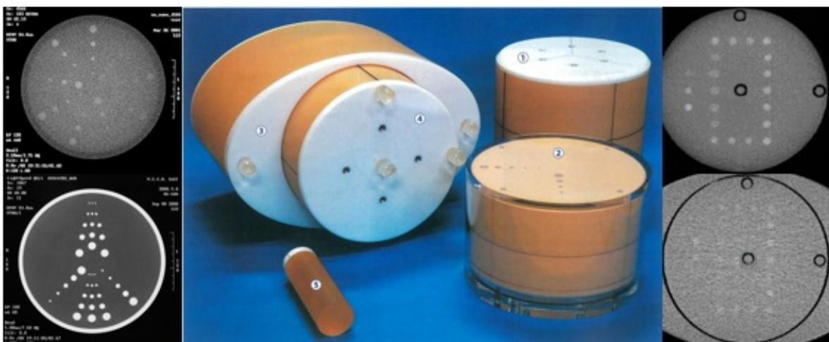
写真6. マルチスライス CT 評価用テストファントム MHT 型
