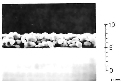
図3 遠心力沈降法で作られた蛍光面
