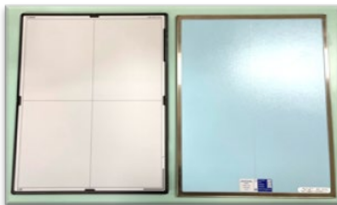
写真 3 : 間接変換方式フラットパネルディテクタ Canon CXDI70CWireless
